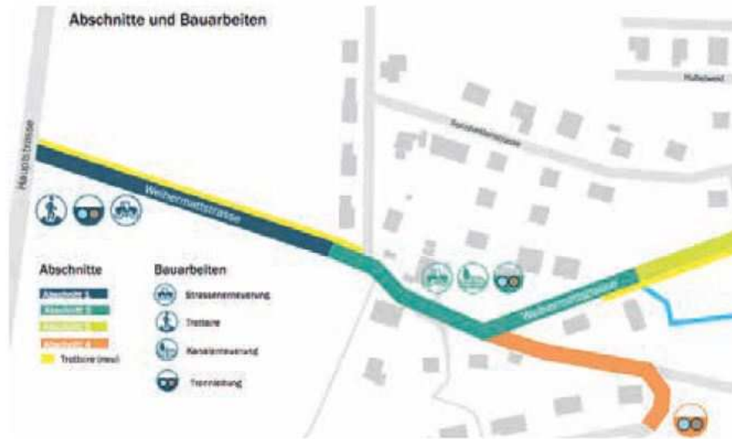
Die Weihermattstrasse samt Kanalisation soll bis 2021 in vier Etappen saniert respektive erneuert werden. Plan zvg
